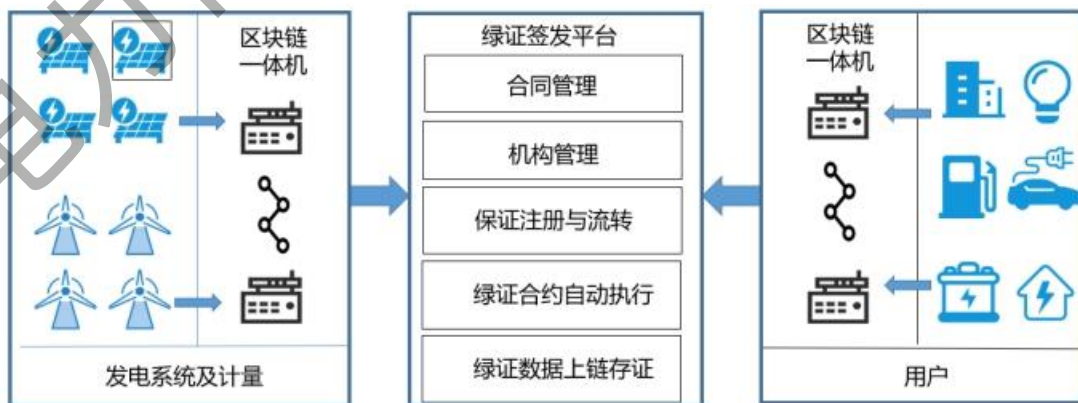
图 3.1.1.2-2 基于区块链的可再生能源电力消纳架构
